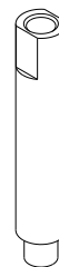
x1 Tercer Poste Opcional Puede venir pre-instalado en la cerradura y se puede quitar con alicates
